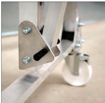
Mango de agarre para ajuste de altura
